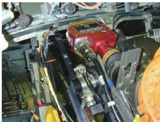
图3 车身激光钎焊缝的激光检测
